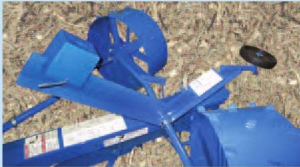
ギャザリングチェーンのサイレージ切り込み深さコントロールはスイベルホイールの蝶ナット及び釣合い重りの調整でサイレージの掻き出し量を設定します。これにより98Cサイロアンローダーは、設定したサイレージの量を右回転しながらサイロ底部まで一定量均一に排出します
